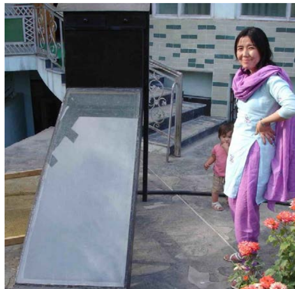
Un séchoir solaire indirect pour les aliments en Afghanistan Crédit photo: Robert Foster, Winrock International.
