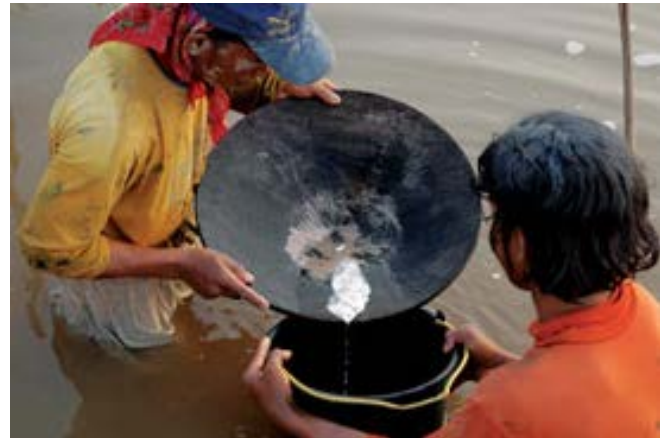
Figure 2. Lavage au mercure en eau libre en Indonésie. Source: http://news.ubc.ca/ubcreports/2005/05dec01/mercury.html
